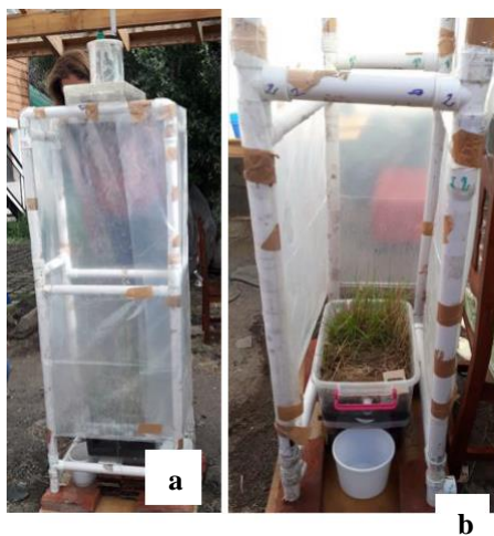
Fig. 2. Ensayo de lluvia simulada sobre microparcels de hidrosiembra. (a) simulador de lluvia con cortina de nylon de alta densidad, (b) microparcels de hidrosiembra con geotextil de coco en el simulador de lluvia.
